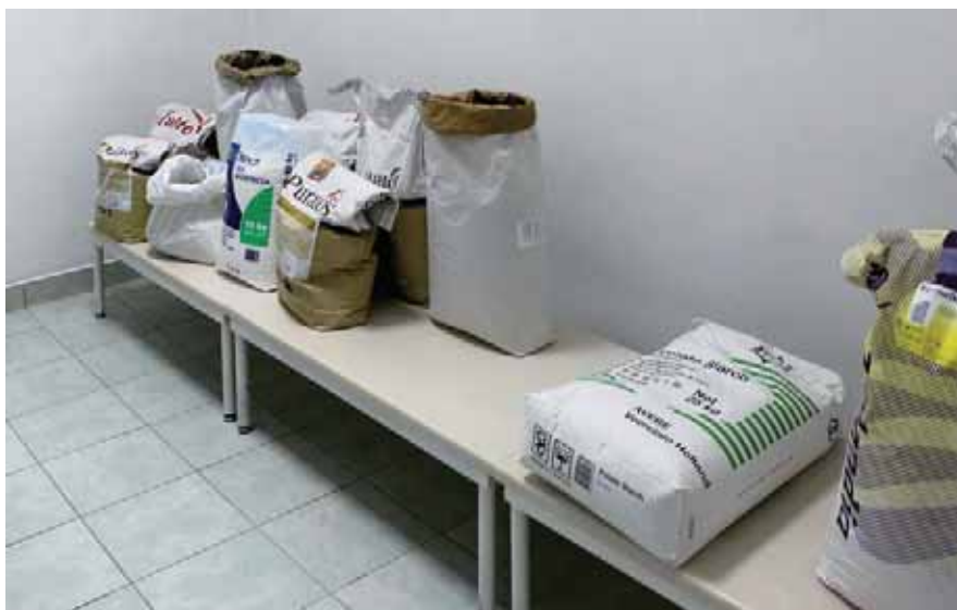
Fot. 13. Pomieszczenie magazynu dodatków z podestami do składowania izolującymi od podłogi.
