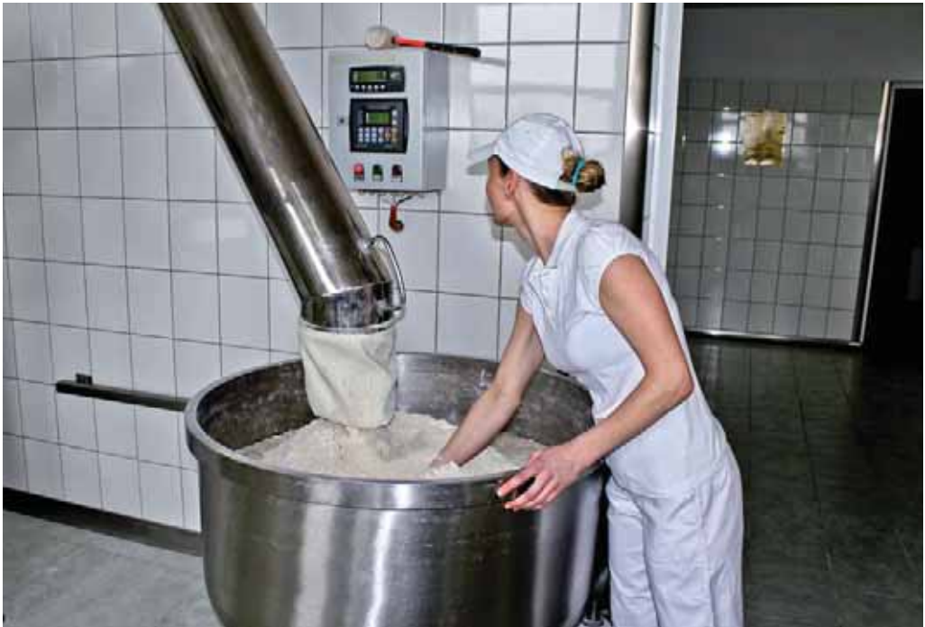
Fot. 8. Stanowisko automatycznego dozowania mąki do dzieży wraz z elektronicznie nastawianą ilością dodawanej mąki.
