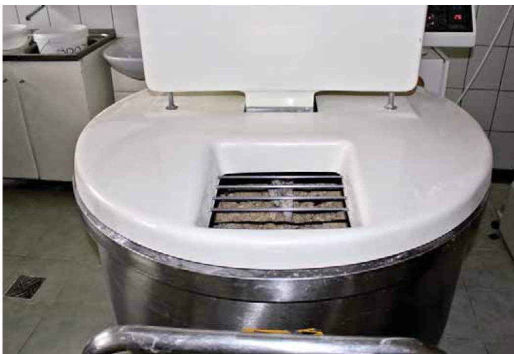
Fot. 3. Mieszarka do ciast wyposażona w osłonę ochronną, zabezpieczającą przed wkładaniem rąk do dzieży.
