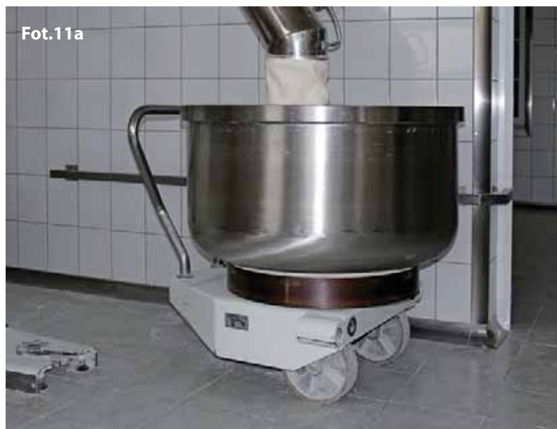
Fot. 11a i 11b. Dzieże do ciasta wyposażone w koła ułatwiające transport ciasta na terenie zakładu.
