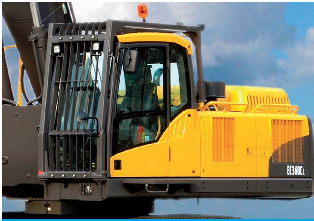
Kabina koparki zabezpieczona stalową kratą.
