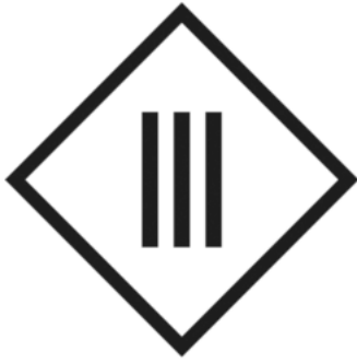
Rys. 3. Oznakowanie elektronarzędzia III klasy ochronności.
