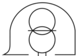
Rys. 5. Oznakowanie transformatora separacyjnego przeznaczonego do stosowania na terenie budowy.
