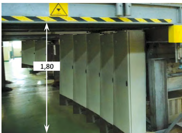
Rys. 7-2. Przykład oznakowania barwami bezpieczeństwa elementu obniżającego wysokość dojścia do stanowiska pracy (źródło: CIOP-PIB)
