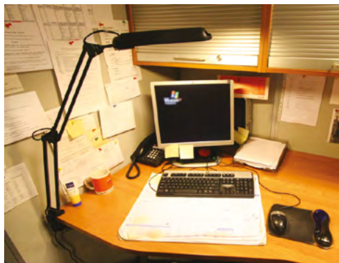
Rys. 3-2. Przykładowy sposób oświetlenia stanowiska z komputerem za pomocą opraw oświetlenia miejscowego (źródło: CIOP-PIB)
