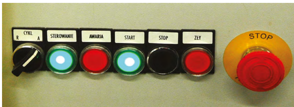
Rys. 7-9. Wskaźniki świetlne i elementy sterownicze wraz z ich opisem (źródło: CIOP-PIB)
