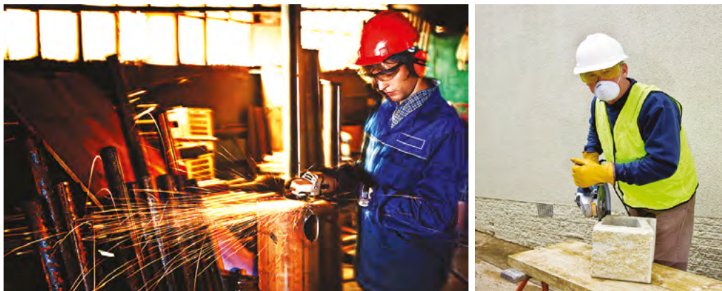
Rys 7-14. Przykłady środków ochrony indywidualnej (zatyczki lub nauszniki, okulary, hełmy ochronne, rękawice, kamizelki ostrzegawcze, maseczka do ochrony układu oddechowego) oraz odzieży roboczej stosowanej przy pracach z wykorzystaniem szlifierki kątowej (źródło: fot. Prometeus, fot. Tonypix, Bigstockphoto)
