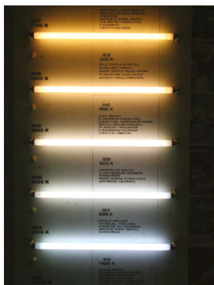
Rys. 3-3. Barwy światła białego i przykłady barwy światła emitowanej przez typowe świetlówki (źródło: CIOP-PIB)
