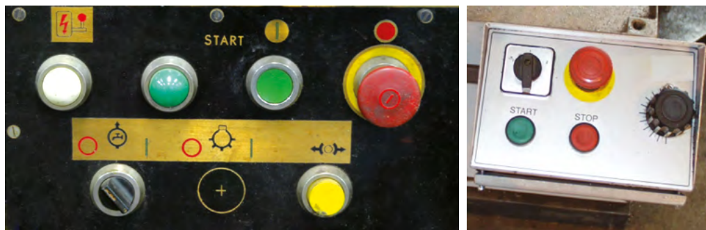
Rys. 7-7. Przykłady oznakowania przycisków elementów sterowniczych napisami i symbolami (źródło: CIOP-PIB)
