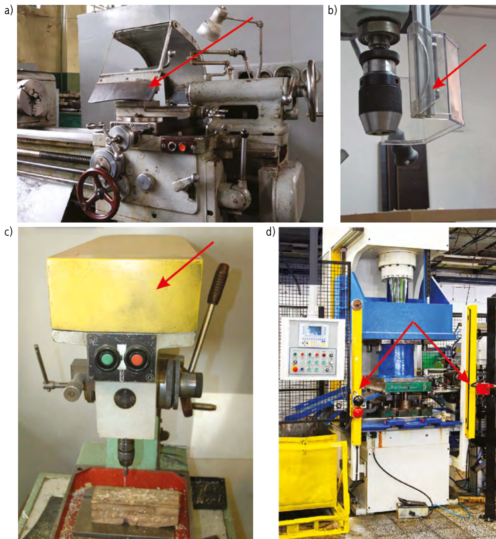
Rys. 7-10. Przykłady zastosowania osłon i urządzeń ochronnych przy maszynach: a) osłona strefy skrawania tokarki poruszająca się wraz z suportem (źródło: fot. Withgod, Bigstockphoto), b) osłona nastawna uchwytu wiertarki stołowej (źródło: fot. Dragang, Bigstockphoto), c) osłona stała pełna układu napędowego wiertarki stołowej (źródło: CIOP-PIB) d) kurtyna świetlna zabezpieczająca przed przypadkowym wtargnięciem do strefy roboczej (niebezpiecznej) (źródło: fot. Baloncici, Bigstockphoto)
