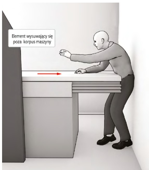
Rys. 7-3. Zagrożenie urazem przez wysuwający się element maszyny (źródło: CIOP-PIB)
