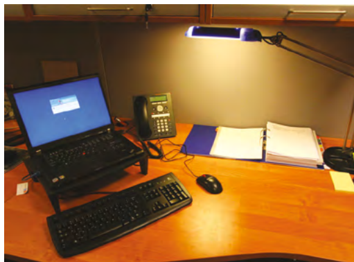
Rys. 3-2. Przykładowy sposób oświetlenia stanowiska z komputerem za pomocą opraw oświetlenia miejscowego (źródło: CIOP-PIB)
