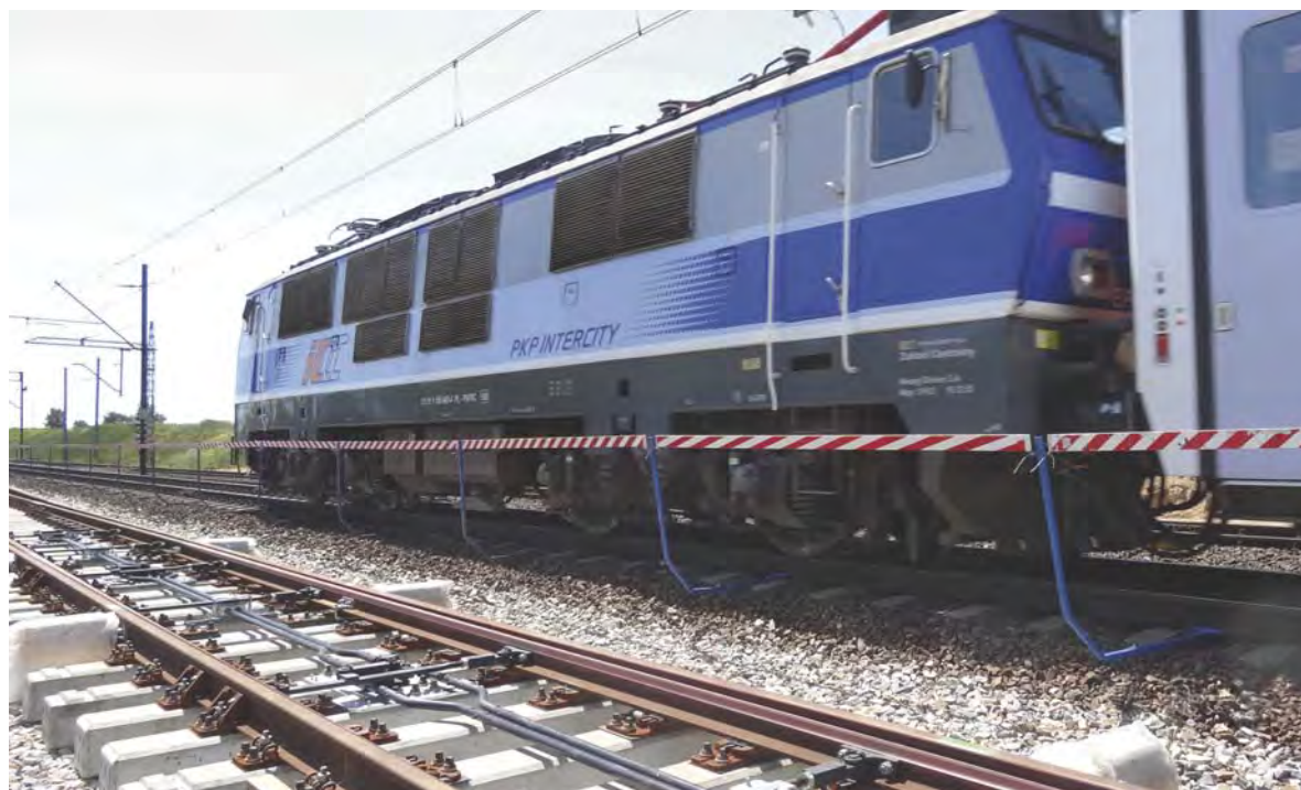
Fot. 17. Przejazd pociągu osobowego z prędkością 100 km/h za wygradzeniem miejsca prac stałymi barierami
