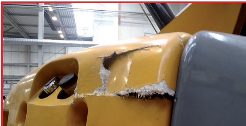
Mechaniczne uszkodzenia obudowy to skutek braku widoczności w strefie manewrowania wózkiem.
